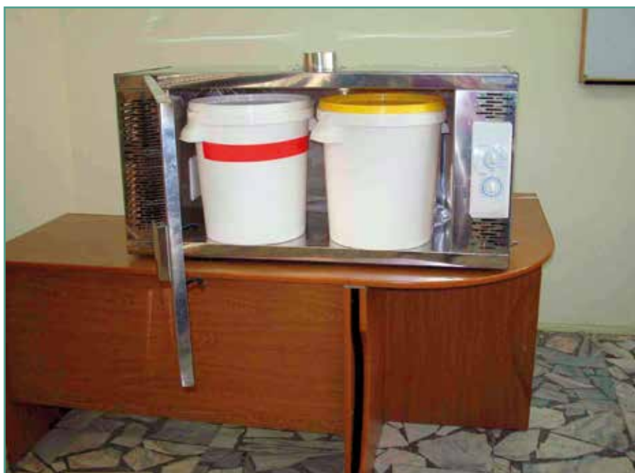
СВЧ-установка для обеззараживания медицинских отходов УОМО-01/150-О-ЦНТ
